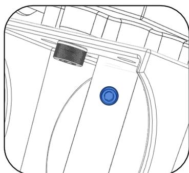
Per un collegamento senza gioco, serrare la vite di arresto opzionale superiore (se presente) sull'albero della valvola di controllo. In caso di smontaggio dell'attuatore, anche questa deve essere preventivamente allentata.
