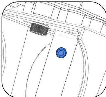
Für eine spielfreie Verbindung ist der obere optionale Gewindestift (sofern vorhanden) an der Regelventilwelle anzuziehen. Bei einer Demontage des Antriebes muss diese auch wieder vorher gelöst werden.
