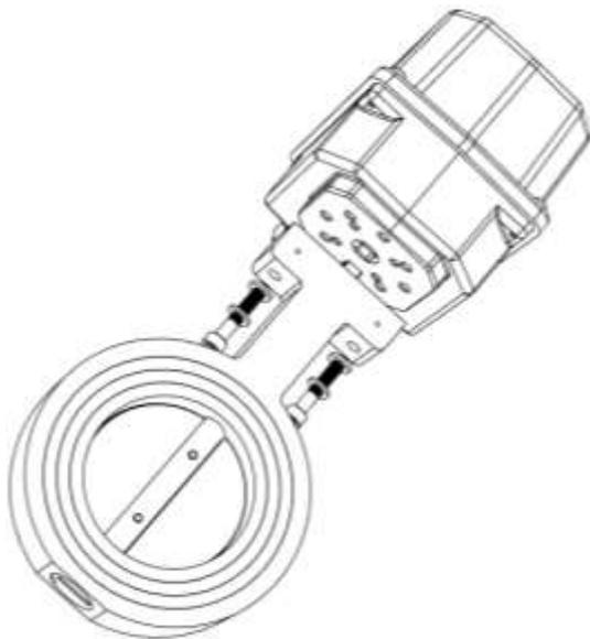
Para montar un actuador Schimpf en una válvula de regulación, el cuadrado externo del extremo del árbol de la válvula se inserta en el cuadrado interno del actuador. Asegúrese de que el cuadrado interior del actuador y el cuadrado exterior de la compuerta tengan el mismo tamaño. La compuerta se fija con los dos tornillos de cabeza hexagonal que se adjuntan. Durante el montaje, asegúrese de que el actuador esté en la posición correcta con respecto a la compuerta (abierto o cerrado).
